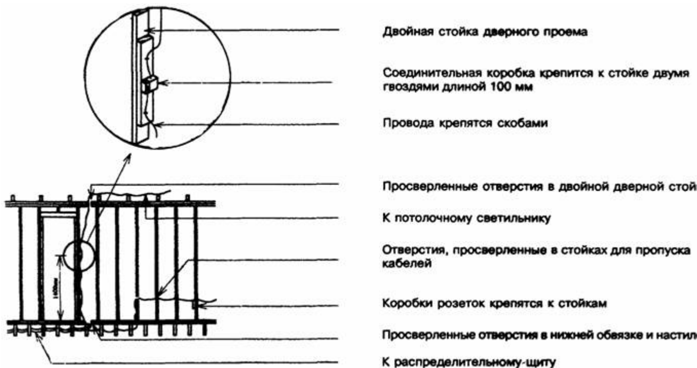
Рисунок 13-9 — Прокладка электрических проводов в элементах каркаса
